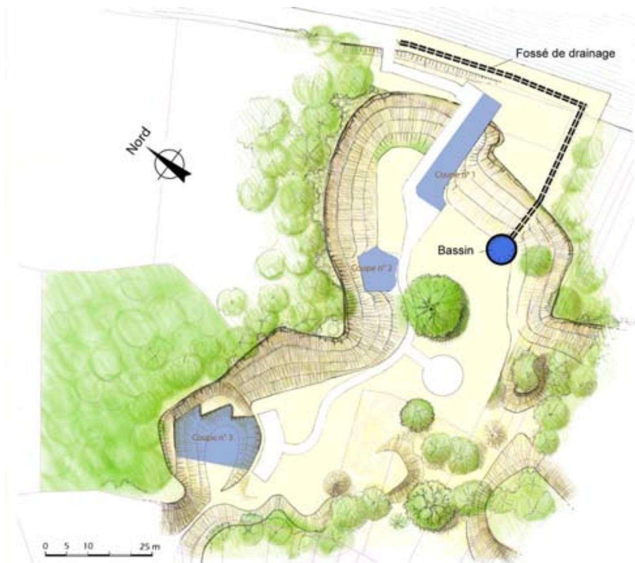
Fig. 29 – Fossés et bassin d'épuisement des eaux pluviales
